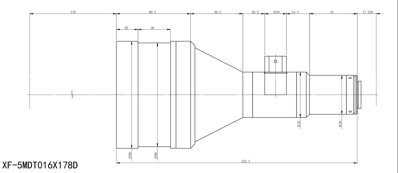
**主要参数** 光学结构 双远心 0. 16 Ф56. 3mm Ф9тт  $178 \text{mm} \pm 3\%$ 远心度 景深 <0.05° 32.8mm 光圈分辨力 F8 33 µ m >0.3@1311p/mm <0.1% 像方MTF 光学畸变测量范围:
